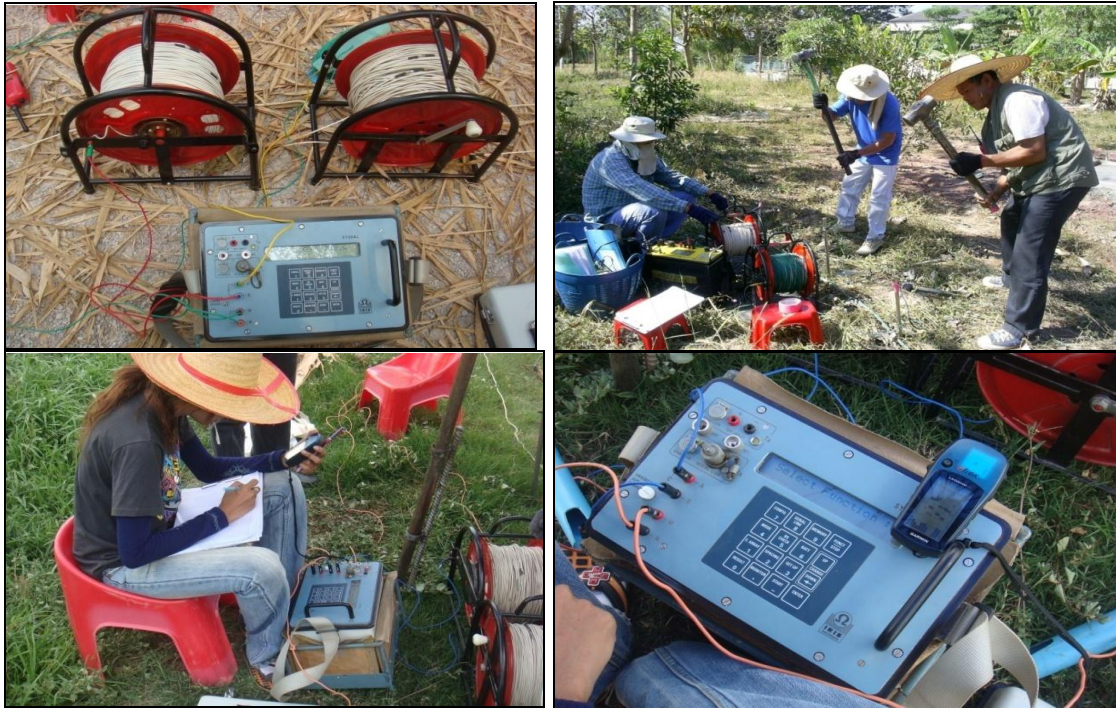
ภาพที่ 1 การสำรวจทางธรณีฟิสิกส์ ด้วยวิธีการสำรวจความต้านทานไฟฟ้าจำเพาะ
